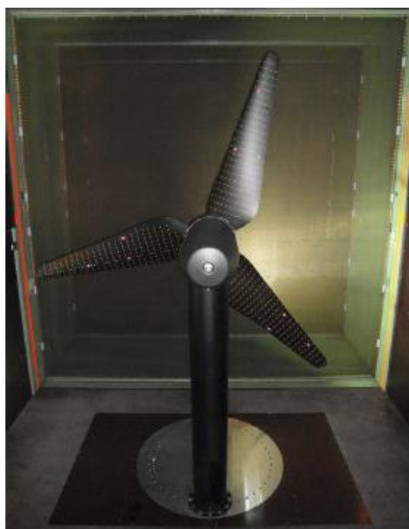
شکل ۵. تصویر پره توربین برت در تونل باد [۱۴]
