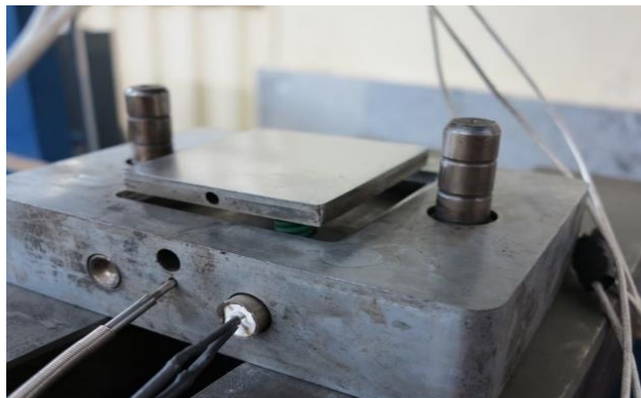
شکل ۱. نحوه قرارگیری صفحه متحرک در قسمت پایینی قالب با مکانیزم فنر
