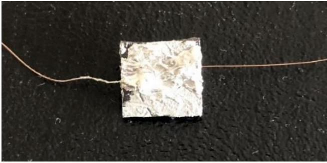
شکل ۳. نمونه آماده شده توسط چسب نقره و سیم مسی به منظور اندازه‌گیری رسانایی الکتریکی
