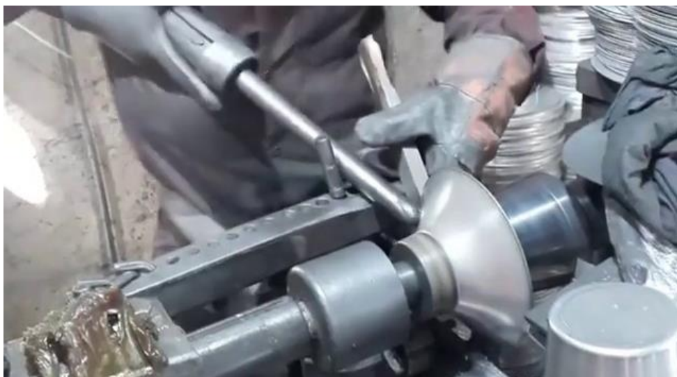
شکل ۲. ساخت سازه‌های آلومینیومی به روش شکل‌دهی چرخشی
