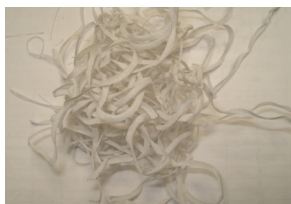
شکل ۴: نمونه براده ممتد تولید شده در سرعت برش بالا
