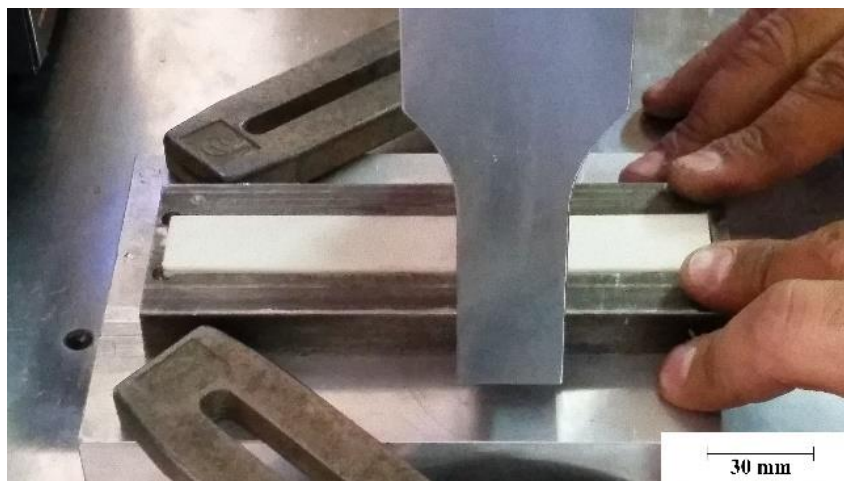
شکل ۲. جوشکاری فراصوتی بازوها روی همدیگر جهت ساخت نمونه ENF
