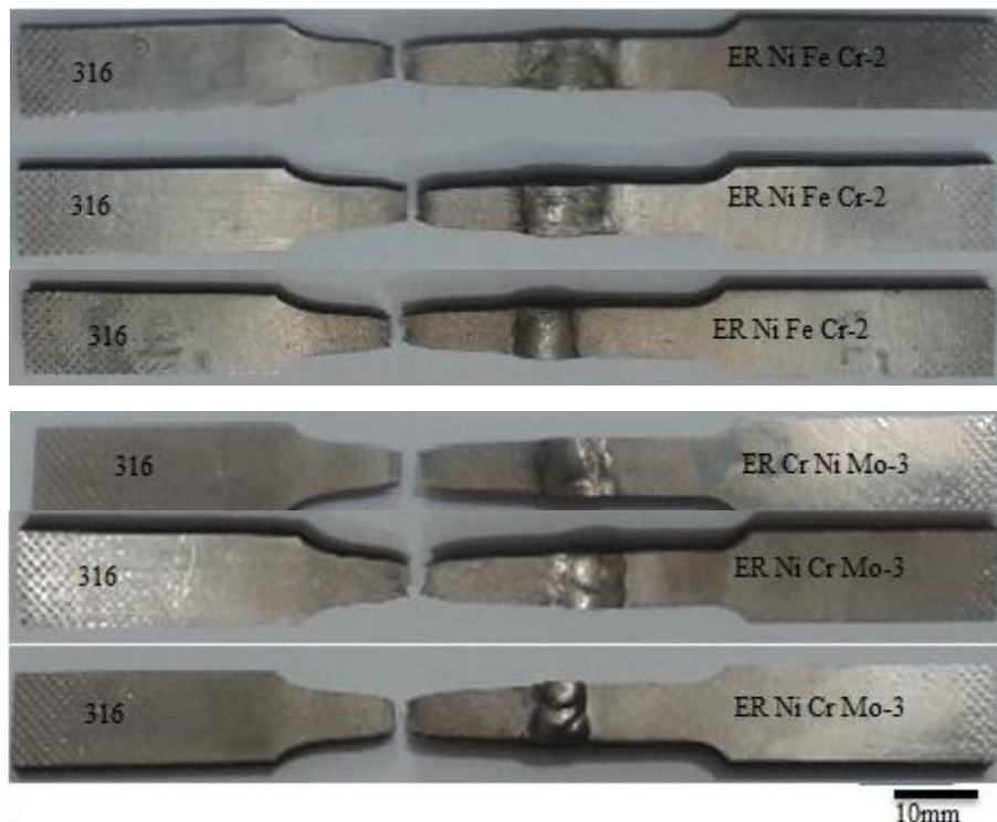
شکل ۱۶. شکست نمونه‌های آزمایش کشش
