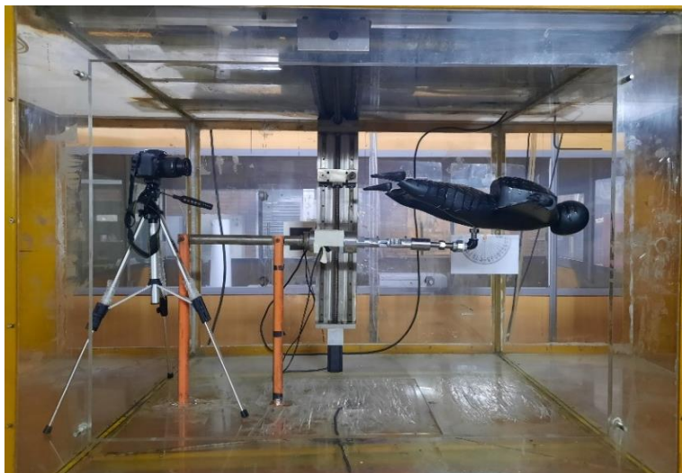
شکل ۱۰. نصب مدل در تونل باد
