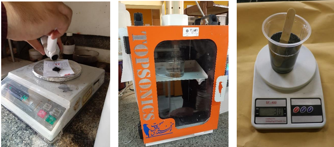
شکل ۲. فرآیند میکس نانو ذرات گرافن با رزین اپوکسی.
