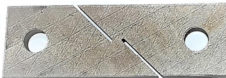
شکل ۶. نمونه آزمون برشی فولاد زنگ نزن 316L ساخته شده به روش ذوب انتخابی لیزر.
