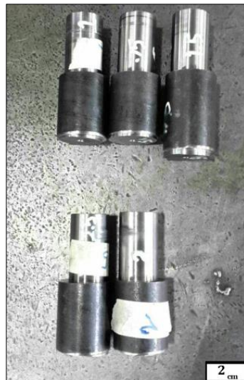
شکل ۴. ابزارهای خارج از مرکز AISI-4340 برای اعمال بار با دامنه‌های معین
