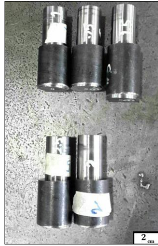
شکل ۴ ابزارهای خارج از مرکز AISI-۴۳۴۰ برای اعمال بار با دامنه‌های معین
