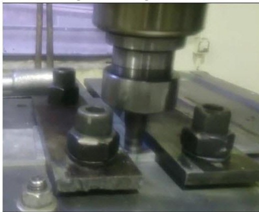
شکل ۲: الف) شماتیک فرآیند جوشکاری در فیکسچر، ب) آزمایش تجربی جوشکاری اصطکاکی اغتشاشی لبه روی هم Figure 2: a) Schematic of the welding process in the fixture, b) Experimental test of friction stir lap welding
