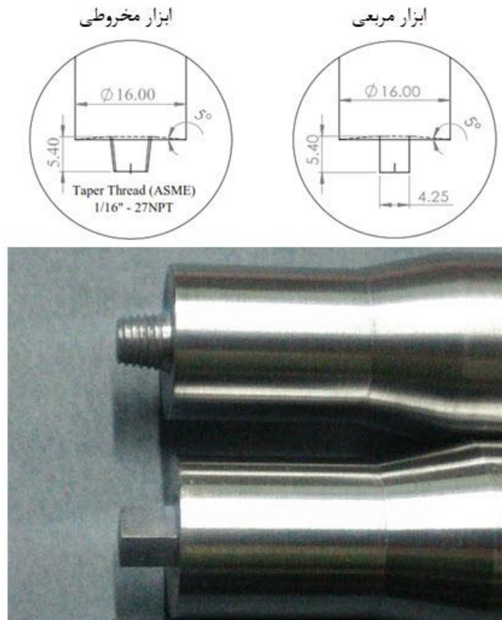
شکل ۱. ابزارهای جوشکاری اصطکاکی اغتشاشی طراحی و ساخته شده (تمامی ابعاد برحسب میلی‌متر است)
