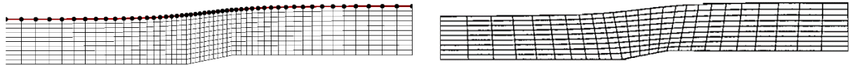
شکل ۴. مقایسه حالت نهایی سطح آزاد. چپ) حلگر پیش فرض (نقاط مشکی رنگ) و حلگر توسعه داده شده (خط قرمز رنگ)، راست) موزافریجا و پریک [۱۵]
