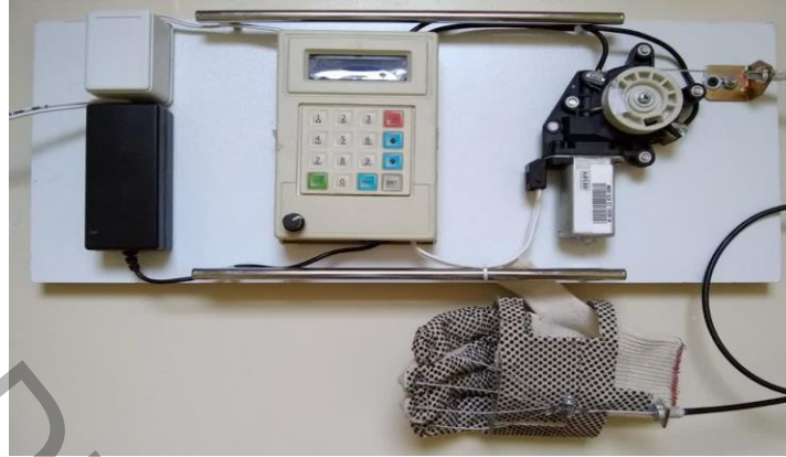
شکل ۹: ساختار نهایی نمونه اولیه سیستم توان بخشی انگشتان دست
