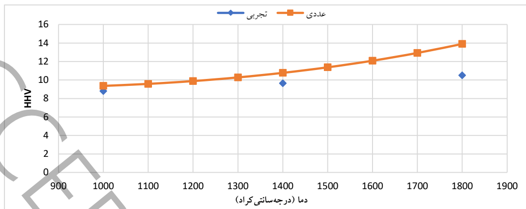
شکل ۱۷ مقایسه داده‌های عددی و تجربی ارزش حرارتی بالا گاز سنتزی Fig. 17 Comparison of numerical and experimental data of high heating value of gas synthesis
