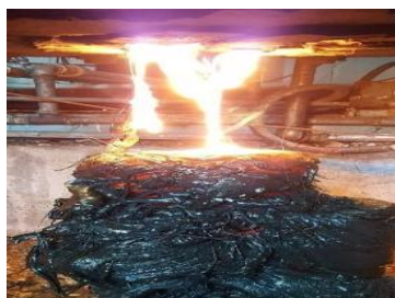
شکل ۱۱ سرباره داغ خارج شده از گازساز Fig. 11 Hot slag removed from the gasifier
