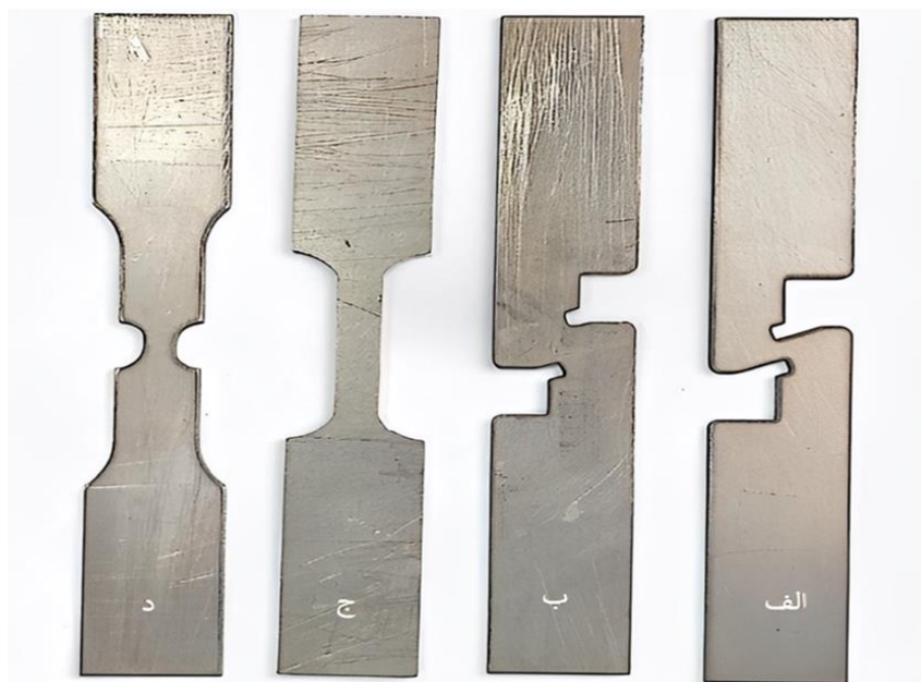
شکل ۲. (الف) نمونه برشی ۱ با سه محوره تنش ۰/۰۸، (ب) نمونه برشی ۲ با سه محوره تنش ۰/۲، (ج) دمبلی شکل با سه محوره تنش ۰/۳۳، (د) نمونه شیاردار با سه محوره تنش ۰/۵.
