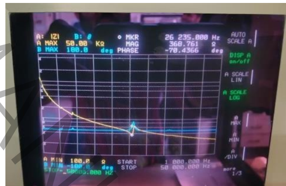
شکل ۱۲: نمودار اندازه‌گیری فرکانس رزونانس استاتور با استفاده از دستگاه امپدانس آنالایزر Fig. 12. Diagram of stator resonance frequency measurement using impedance analyzer
