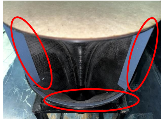
شکل ۳. محل قرارگیری زبری سطح در دهانه ورودی اینولاکس
