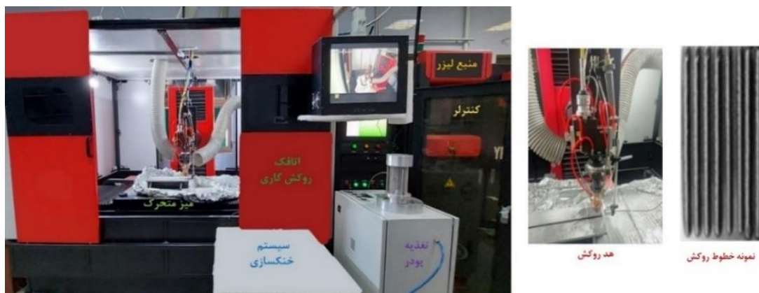
شکل ۶. سیستم روکش کاری لیزری و اجزای اصلی آن با یک سری خطوط روکش
