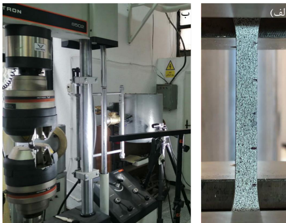
شکل ۳. آزمون مکانیکی الف) نمونه دمبلی آماده شده برای روش همبستگی تصویری دیجیتال ب) دستگاه کشش و دوربین برای کرنش سنجی توسط روش همبستگی تصویری دیجیتال
