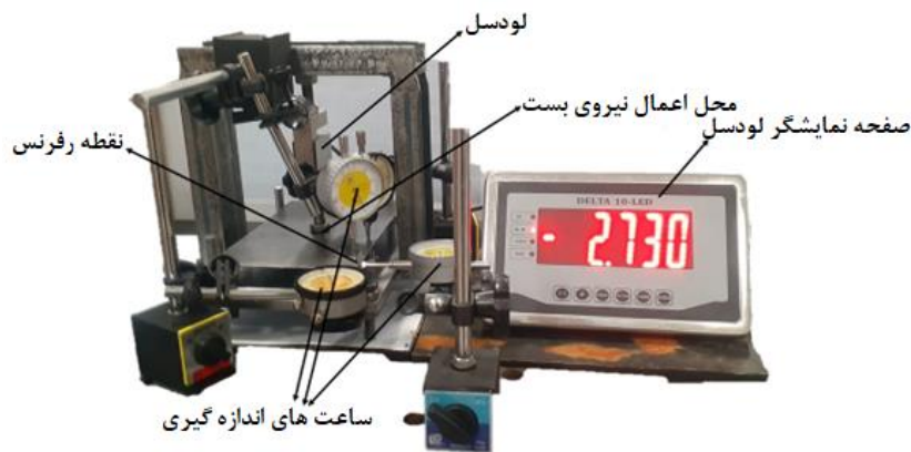
شکل ۸. نحوه اندازه‌گیری انحراف قطعه کار (با اعمال نیروی بست و اغتشاش)
