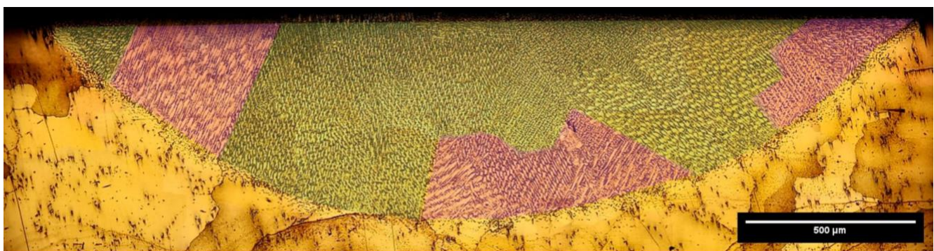
شکل ۴. تشکیل دندریتهای هم محور در مناطق بالای حوضچه که با رنگ سبز نشان داده شده اند و رشد اپیتکسیال و رقابتی دندریتهای ستونی در مناطق نزدیک به خط ذوب که با رنگ صورتی نشان داده شده اند.
