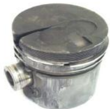
شکل (۱۳): پیستون آسیب دیده موتور بنزینی در اثر خستگی حرارتی-مکانیکی در ناحیه تاج [۱]
