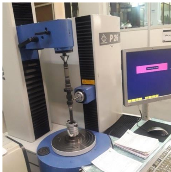
شکل ۵. (الف) دستگاه اندازه گیری هندسه دندان GMM در این مطالعه و (ب) طرحواره هندسه لید دندان.
