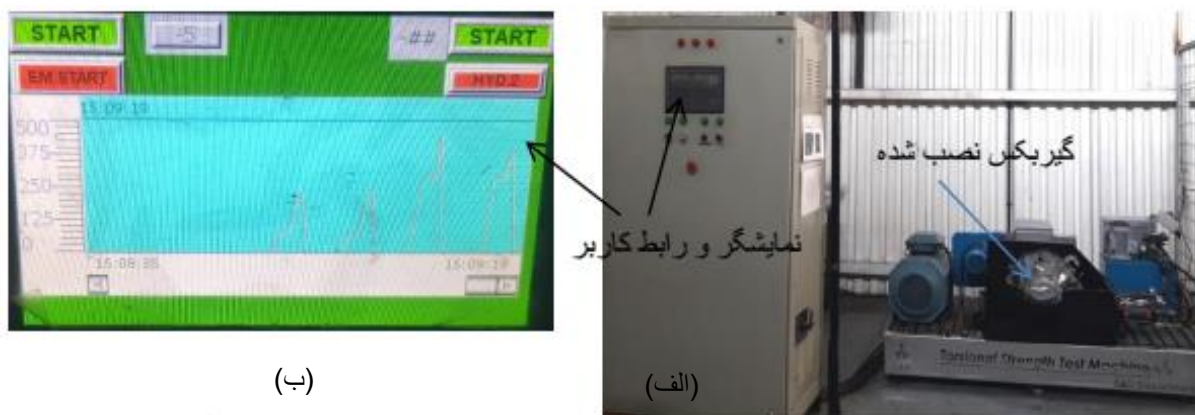
شکل ۳. (الف) سامانه تست استحکام پیچشی، (ب) نمودار و مقادیر گشتاور - زمان ثبت شده آزمون تجربی در نمایشگر سامانه.
