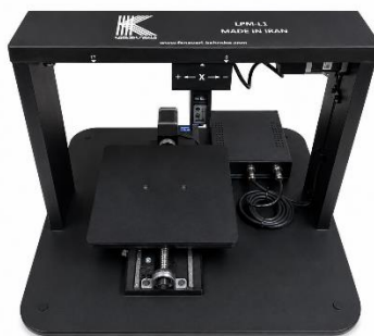
شکل ۳: دستگاه پروفایلومتر لیزری کهربا مدل LPM-L1
