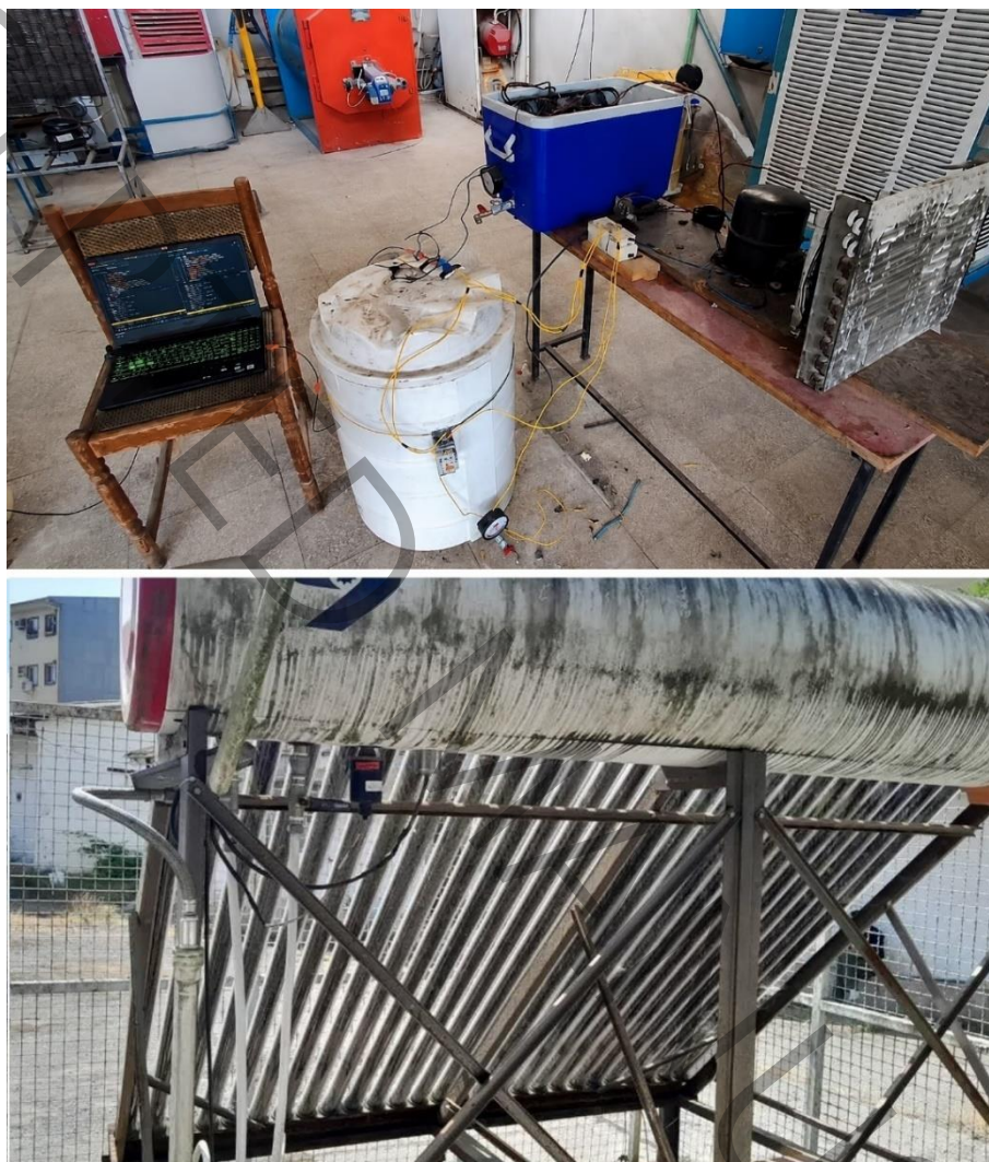
شکل ۱: سیستم پمپ حرارتی خورشیدی انبساط مستقیم ساخته شده Fig. 1: Constructed direct expansion solar heat pump system
