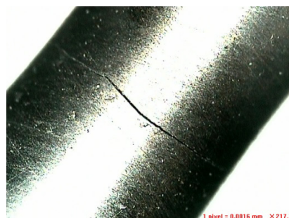
شکل ۱۱: ترک رشد یافته در نمونه که با وی.ام.ام.عکس‌برداری شده است
