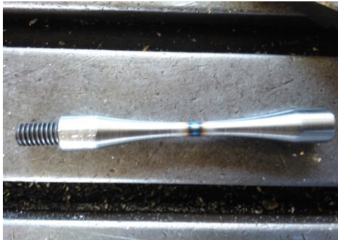
شکل ۵: نمونه گداخته شده بدون اعمال شرایط کنترلی Fig5: Heated sample in without control situation
