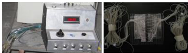
Fig. 3. Pressure tapping's with pressure transducer شکل ۳: تپینگ های فشار به همراه دستگاه فشار سنج
