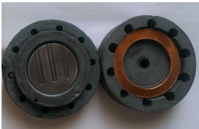
Fig. 3. Geometric parameters of the die شکل ۳: تصویر مجموعه قالب
