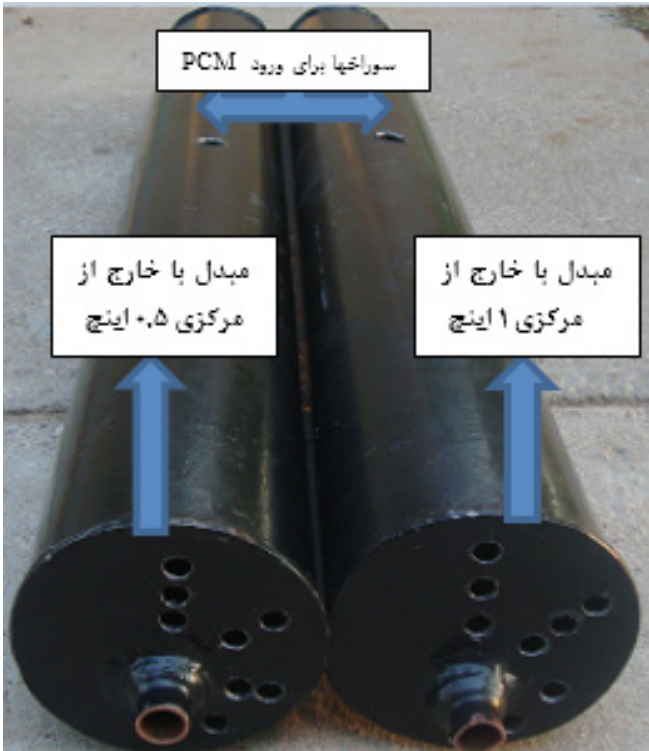
Fig. 3. A view of two eccentric heat exchangers are built شکل ۳: نمای از دو مبدل حرارتی خارج از مرکز ساخته شده
