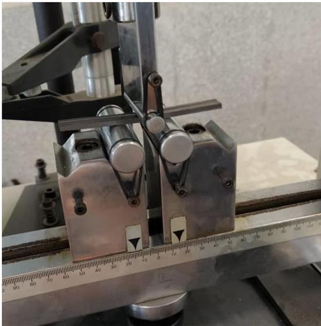
**Fig. 2. Bending test apparatus**
