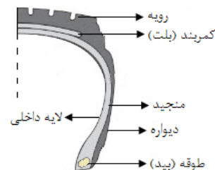
شکل ۱: ساختار تایر رادیال
