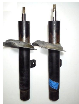
شکل ۱۶: استفاده از اجزای معیوب کمک‌فتر و فتر در سیستم تعلیق جلوی خودرو
