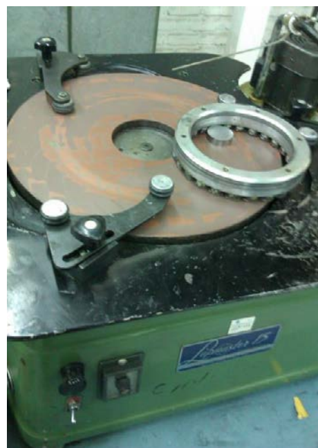
شکل ۲: دستگاه لپن کاری لپ مستر ۱۵ Fig. 2: Lapmaster 15 lapping machine
