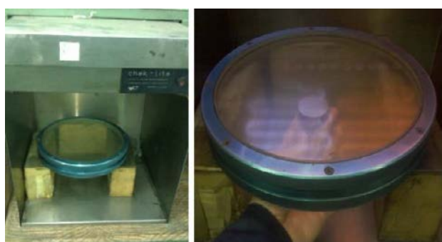
شکل ۴: تختی سنج نوری Chek-Lite Fig. 4: Chek-Lite optical flat
