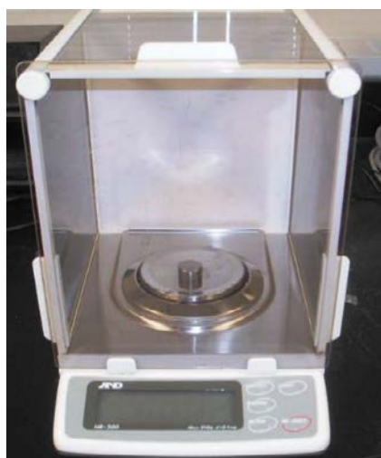
شکل ۵: ترازوی الکترونیکی HR-۲۰۰ Fig. 5: HR-200 precision electronic balance
