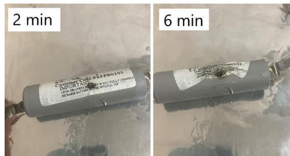
شکل ۶: باتری GB 2565 پس از آزمایش نفوذ مکانیکی با فشار تنظیم‌کننده ۵ bar و سرعت برخورد ۹/۲ m/s که منجر به سوراخ شدن بدنه باتری و اتصال کوتاه شد
