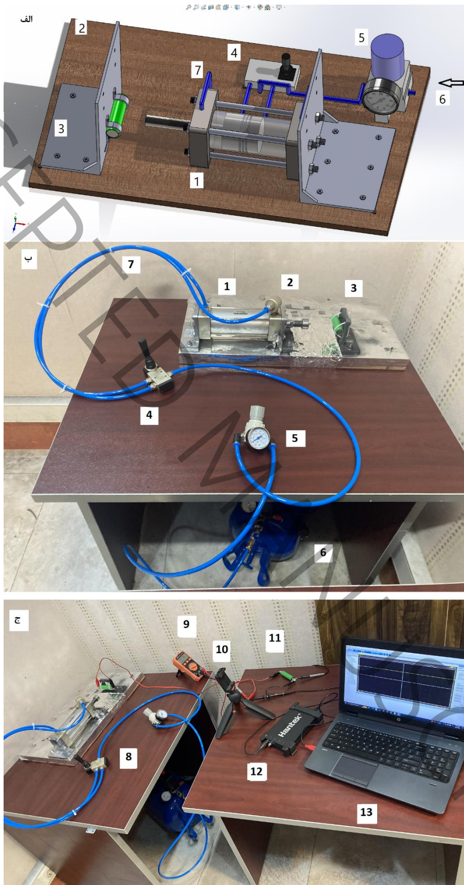
شکل ۴: طراحی سیستم ضربه در نرم افزار Solidworks (الف) و اجرای آن (ب) شامل قطعات سیلندر پنوماتیک (1)، پایه زیرین مجموعه با پوشش ورق آلومینیوم (2)، پایه‌های نگه دارنده جک و باتری در یک راستا (3)، شیر دستی فشار هوا (4)، تنظیم کننده فشار به همراه گیج فشار (5)، شیر دستی (6)، سنسور (7)
