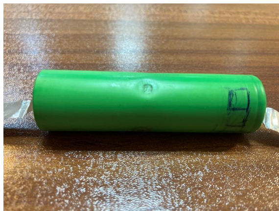
شکل ۸: سلول باتری Sony تی سی ۶ پس از آزمایش نفوذ مکانیکی با فشار ۵ bar تنظیم کننده و سرعت برخورد 9/2 \text{ m/s} در دمای -25^\circ\text{C} که باتری توانست پایداری خود در برابر نفوذ را حفظ کند
