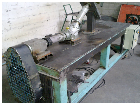
Fig. 1. a) Schematic illustration of the experimental setup b) Outline of the experimental setup, (c) Data collector set شکل ۱: (الف) شماتیک کلی سامانه ارتعاشی گیربکس ۹۰ درجه، (ب) نمای کلی از مجموعه آزمایشگاهی، (ج) مجموعه داده برداری
